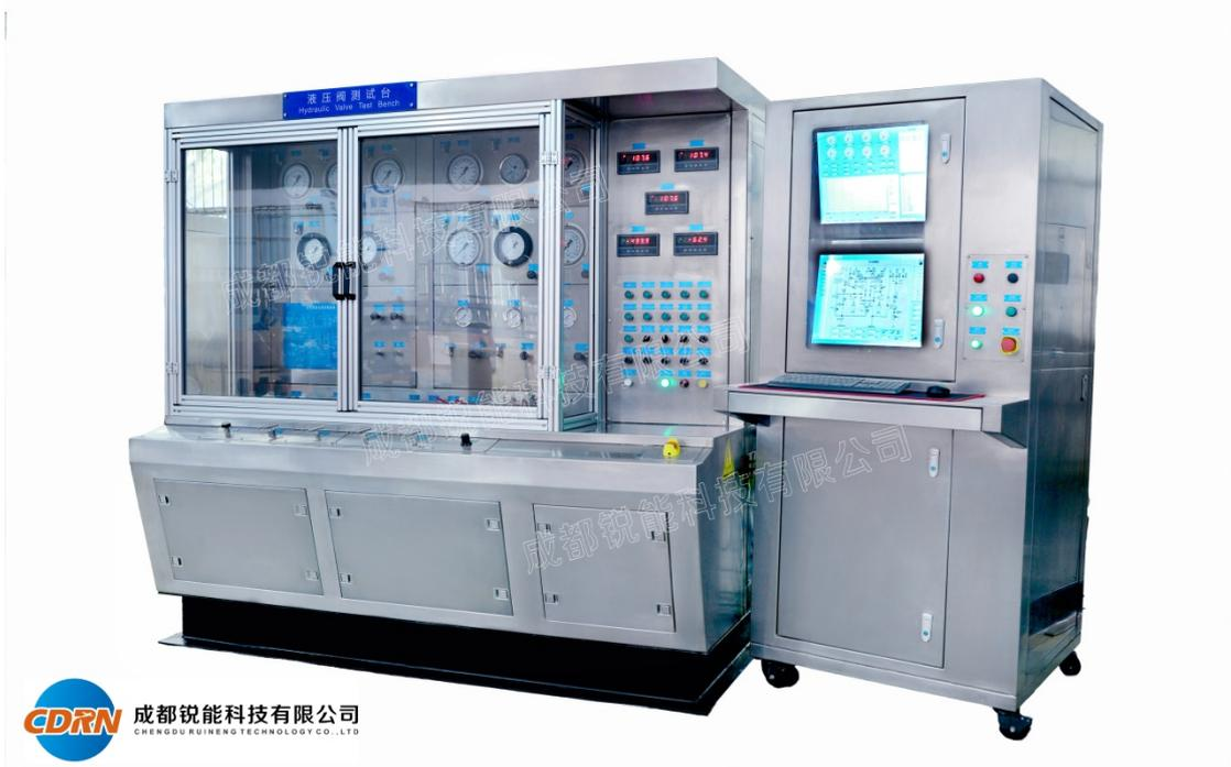
液压阀测试台满足 PTU 选择阀、防火切断阀、优先阀、自增压优先阀等各类液压阀的耐压试验、开启压力试验、复位压力试验、全流量压力试验、压降试验、反向压降试验、内泄漏试验、响应（压降升高）试验、响应（快速流量）试验、PTU 选择阀性能试验、防火切断阀性能试验、搭接电阻测试、绝缘电阻测试等。
