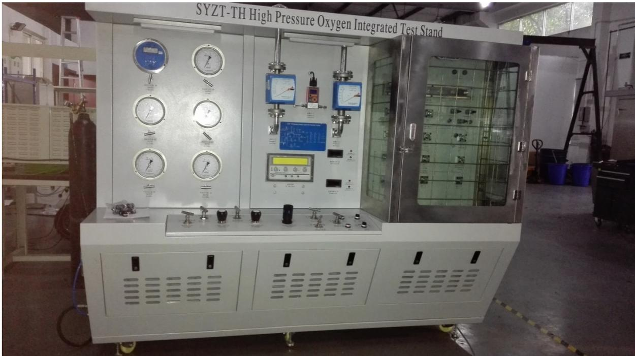
本试验台根据多款军机及民用飞机的氧气附件和氧气仪表的测试需求而设计，充分考虑了氧气附件测试的特殊性和安全性要求。本试验台设计为通用的平台化结构，除满足用户特定的产品测试需求外，后续可根据需求进行扩展，增加测试能力。本试验台测试工作介质为氮气。
